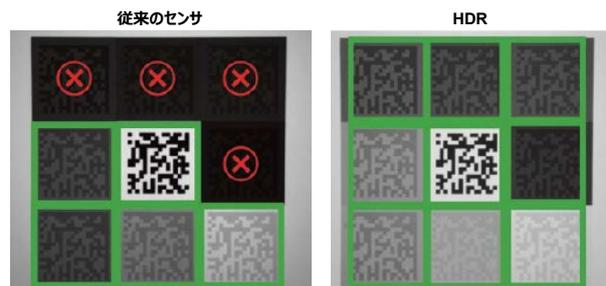
ダークノイズを減らし、サチュレーションを改善し、照明が不十分なコードを読み取る高度な画像センサの採用により、低コントラスト条件下におけるコードの読み取りを可能にします。
