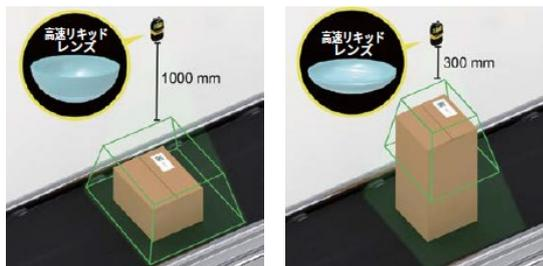
機械部品なしで動的にオートフォーカスを調整し、ばらつきが大きい高速撮像の用途に対応します。
